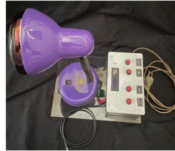
Gambar 3 alat terpai inframerah berbasis Arduino uno.
