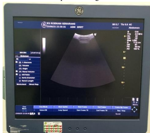
Gambar 3. Citra Hasil Pemindaian Phantom Berbahan Dasar Air, Menunjukkan Objek Uji Kurang Jelas
