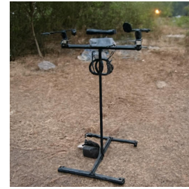
Gambar 7. Pemasangan Kotak Komponen Dengan Rangka.
