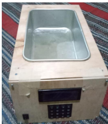
Gambar 5 Alat Paraffin Bath Dengan Kontrol Suhu Secara Otomatis
