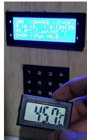
Gambar 5 Pengujian Alat Pada Suhu 45°C
