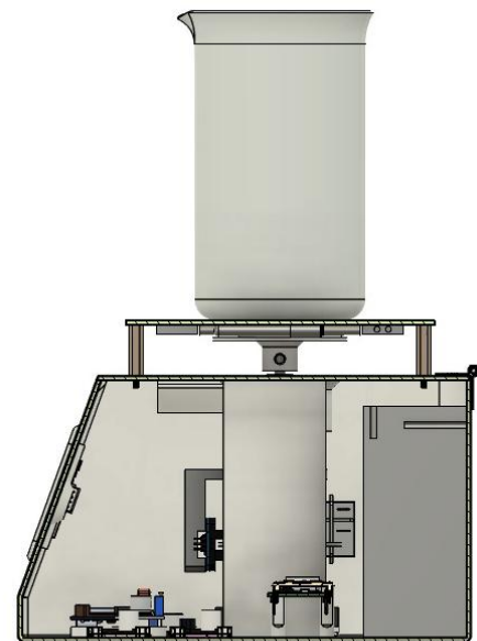
Gambar 3. Desain casing tampak samping dan cover dibuka
