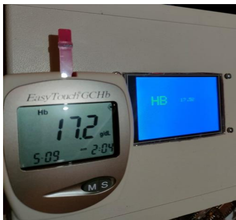
Gambar.4 Perbandingan Alat EasyTouch GCHB dengan Modul.
