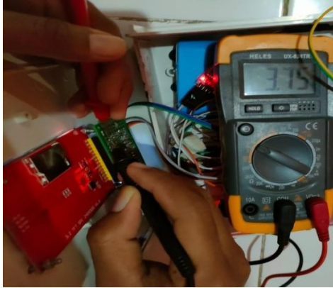
Gambar.2 Pengukuran tegangan input pada LCD TFT
