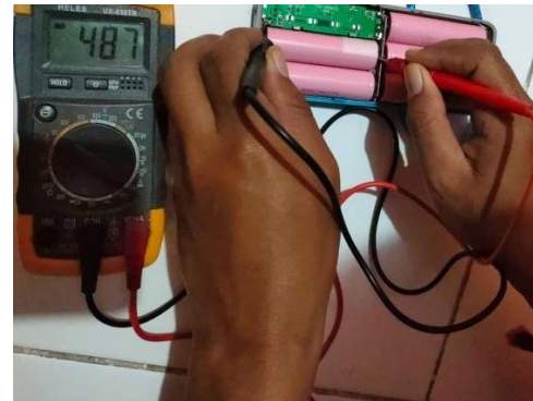
Gambar.1 Pengukuran tegangan pada Baterai
