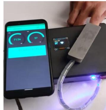
Gambar 9. Pengambilan Data Detak Jantung
