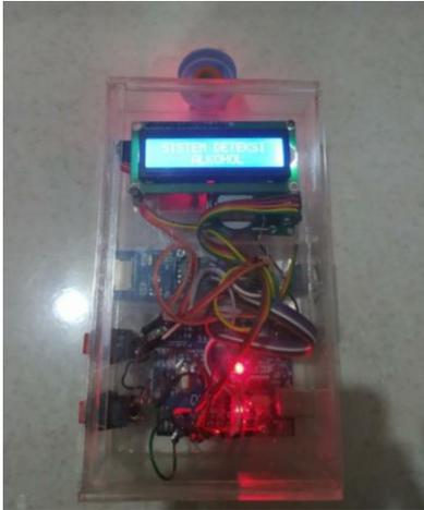
Gambar 4 Alat Detektor Alkohol berbasis Data
