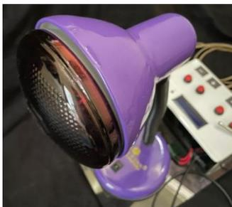
Gambar 1. alat terapi *infrared* dengan *sensor* suhu berbasis mikrokontroler Arduino uno.
