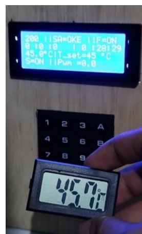
Gambar 5 Pengujian Alat Pada Suhu 45°C
