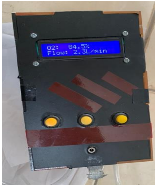
Gambar 5 Pengujian Alat Pada Parameter Flow 2L/Min
